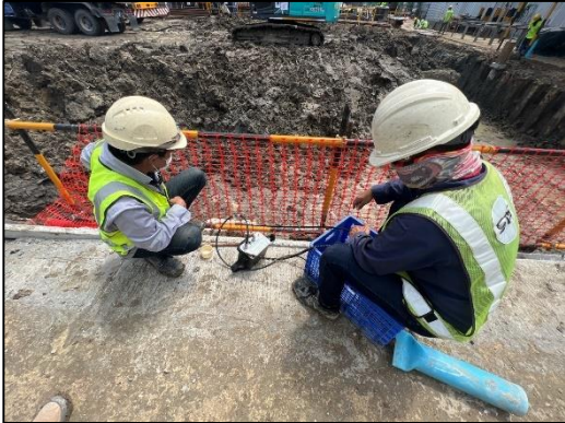
ภาพที่ 29 กิจกรรมตรวจสอบการเคลื่อนตัวของดิน
