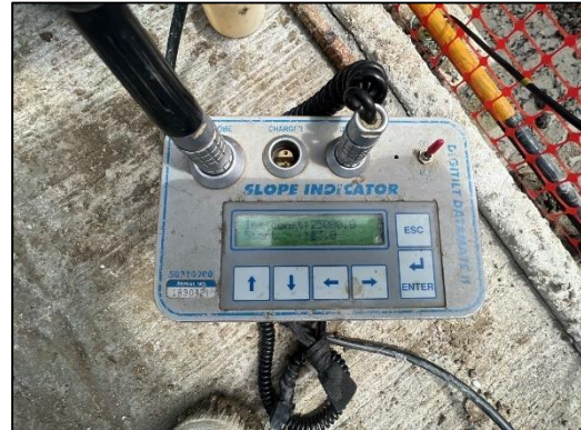
ภาพที่ 29 กิจกรรมตรวจสอบการเคลื่อนตัวของดิน
